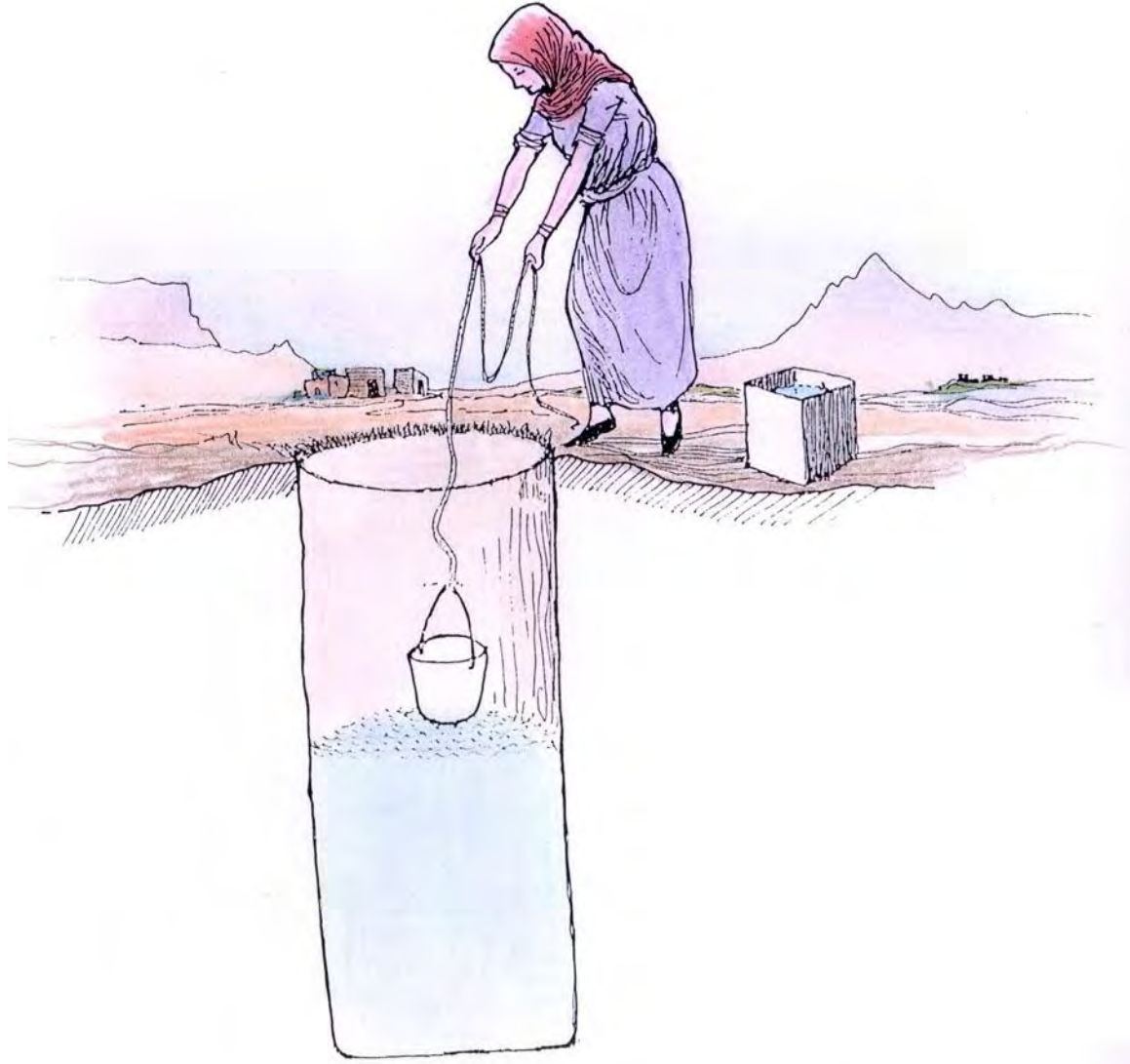
الشكل (74) تلوث المياه بسبب استخدام الدلو وكبر فتحة البئر.
